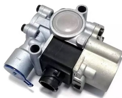
05064VLT клапан элект.магнитный ABS байонет [4721950180] 24V, воздух 2*M22x1,5 , сенсор BAJONET DIN72585
