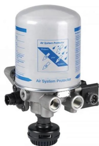
05037VLT пневмокран осушителя 13BAR в сборе [4324251010] [ports: 1,21=M22x1,5, 4=M12x1,5, 12=M16x1,5] VOLVO
