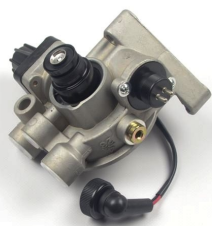
05035VLT площадка осушителя [4324101117] 12,5BAR, 24V (+РДВ+обогрев) [port: 1+21=M22x1,5, 22=M12x1,5]
