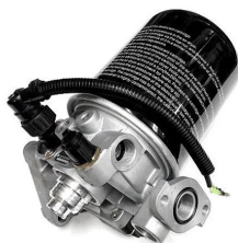
05339VLT осушитель в сборе [9324000020] 12BAR (обогрев, глушитель, клапан, фильтр, РДВ) MB ACTROS/AXOR
