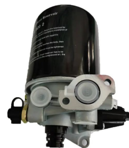
05637VLT осушитель в сборе [9324000030] 10BAR (обогрев, глушитель, клапан, фильтр, РДВ) MB ACTROS/AXOR
