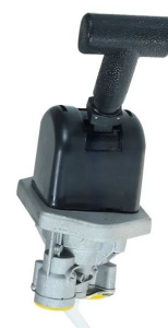
05095VLT пневмокран ручного тормоза P2max=5.9 BAR/Port threads:M16x1.5mm [9617230210] SCANIA/DAF
