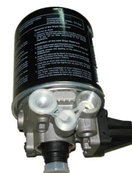
05730VLT осушитель в сборе [4324101110] 12,5BAR, 24V (с фильтром, с обогревом, с глушителем, с РДВ)
