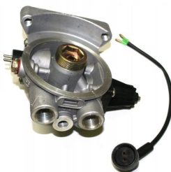
05046VLT площадка осушителя [4324101027] 8,1BAR, 24V (+РДВ+обогрев) [port: 1+21=M22x1,5, 22+4=M12x1,5]
