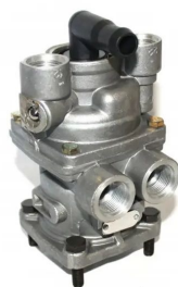
05234VLT пневмокран тормозной Pmax.=10 BAR/Ports: 4xM22x1.5mm [4613152580] MB SK/MK/NG-SERIES
